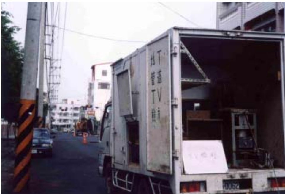
圖 1.30 地下管路電視檢視(TV)車
