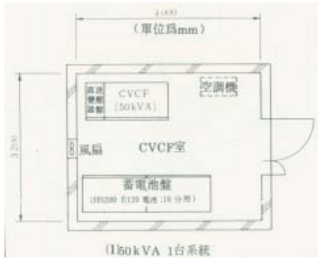
圖 4.9 UPS 系統的配置例(1)
