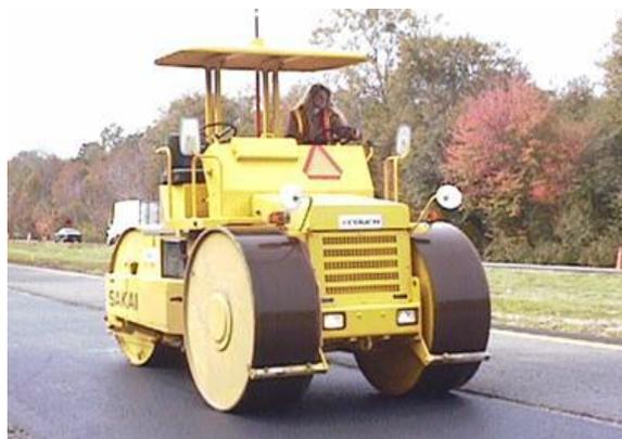
圖 23 二軸三輪壓路機
