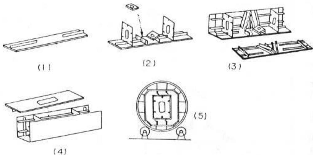
圖 3-9 鋼箱梁組立製程 (例)
