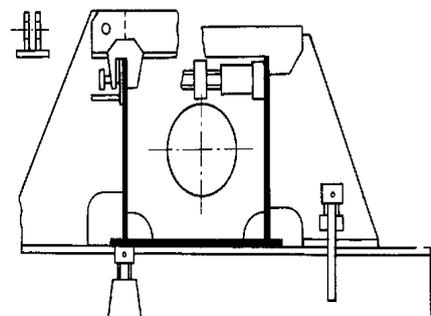
圖 3-14 鋼柱組立治具 (例 1)
