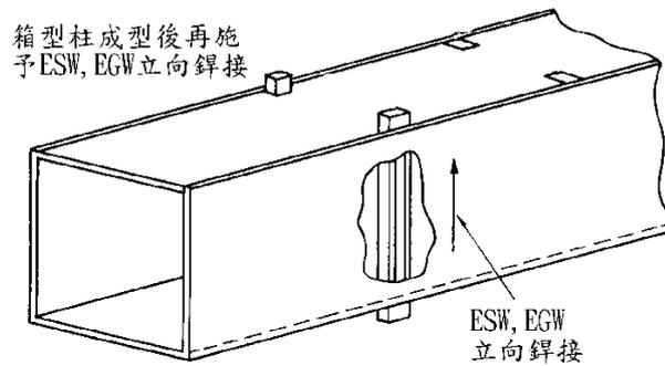
圖 3-12 箱型柱組立製程 (3)
