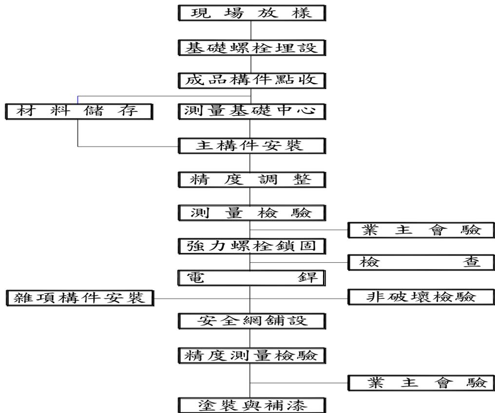
圖 3-37 安裝作業流程
