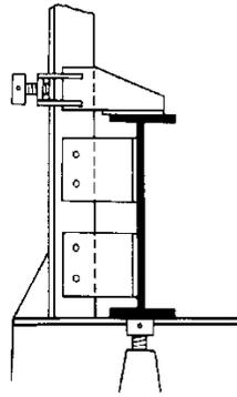
圖 3-15 型鋼組立治具 (例 2)
