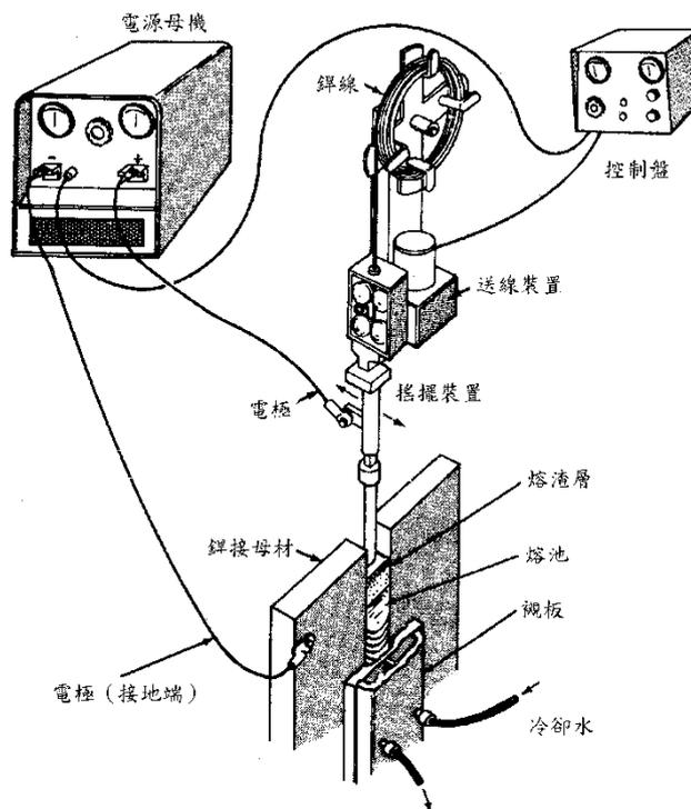
圖 3-26 電熱熔渣銲接之示意圖
