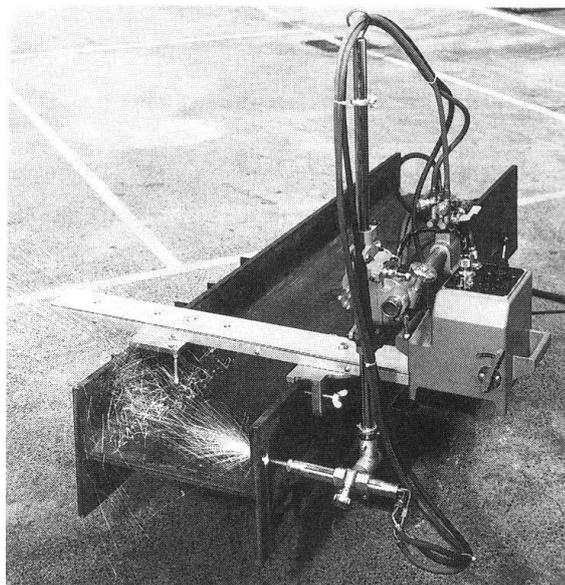
圖 3-2 軌道式氣體火焰切割機操作（例）
