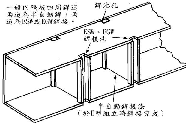
圖 3-11 箱型柱組立製程 (2)
