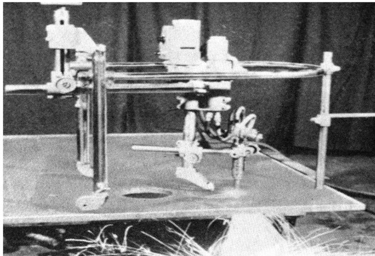
圖 3-8 火焰切割開孔機
