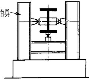
圖 3-16 鋼柱組立治具 (例 2)
