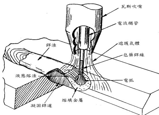
圖 3-22 FCAW 銲接原理（氣體遮護）
