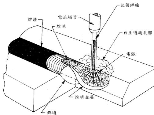
圖 3-21 FCAW 銲接原理（自護式）
