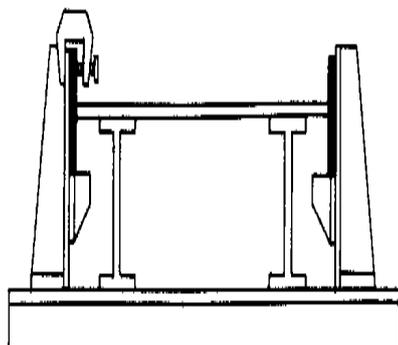
圖 3-13 型鋼組立治具 (例 1)
