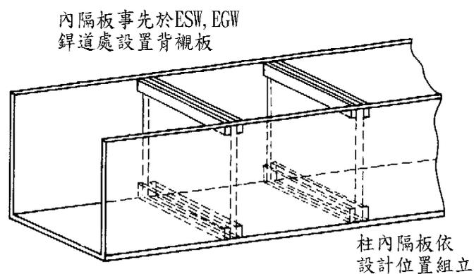
圖 3-10 箱型柱組立製程 (1)
