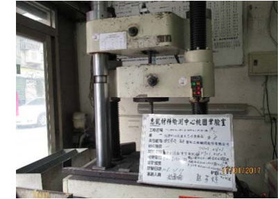
鋼筋拉伸試驗
