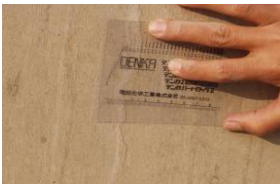
圖 3：測量裂縫的寬度
