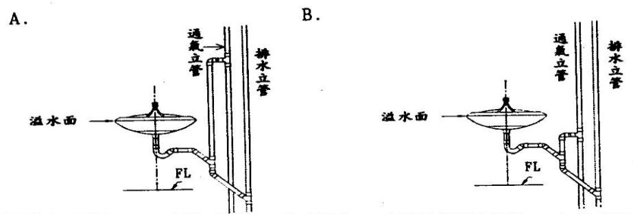
2. 下圖中右側之設備為飲水機，其排水方式採用間接排水，請問何者之通氣管連接方式正確？
