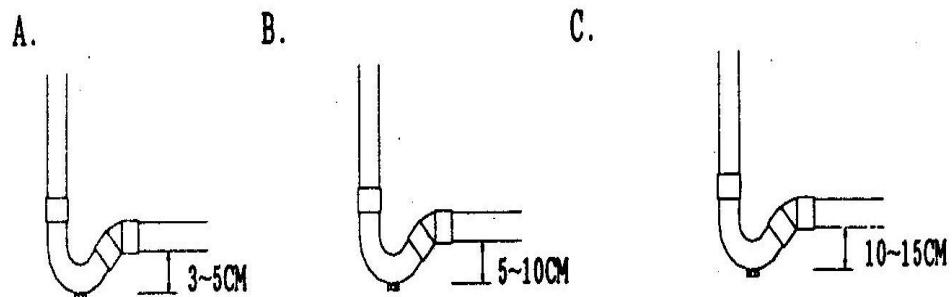
17. 給水箱之溢流管與箱底洩水管及止水閥之連接應為何？
