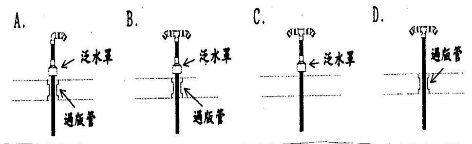
9. 下圖為連接數個衛生器具之排水橫支管，請問何者之通氣管與排水橫支管之連接方式正確？
