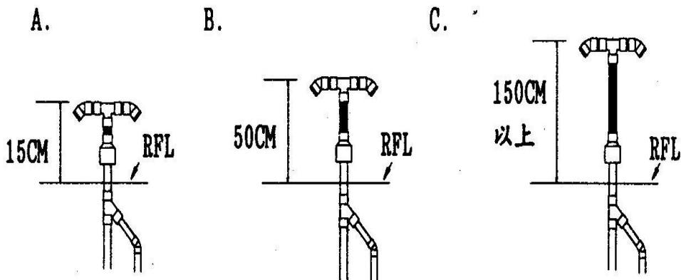
23. 連接抽水泵之防震軟管、閘閥及逆止閥之接法，試問何者正確？
