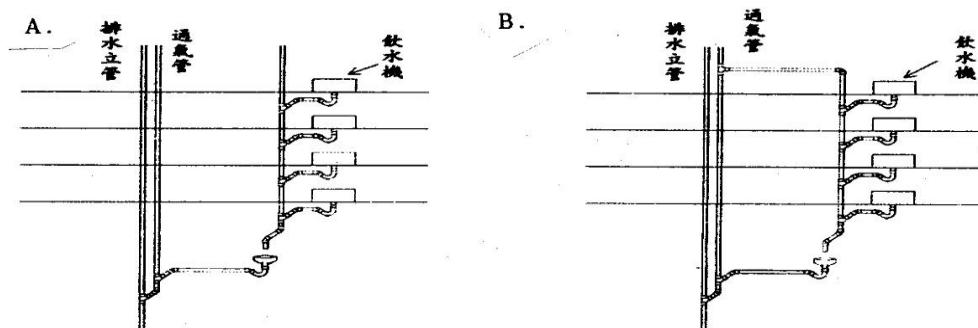
3. 下圖為衛生器具排水橫支管之連接方式，何者正確？
