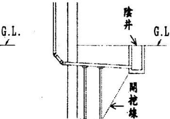
12. 下圖為器具排水管接入排水橫管（或排水立管於轉彎處）之配管方式，何者正確？
