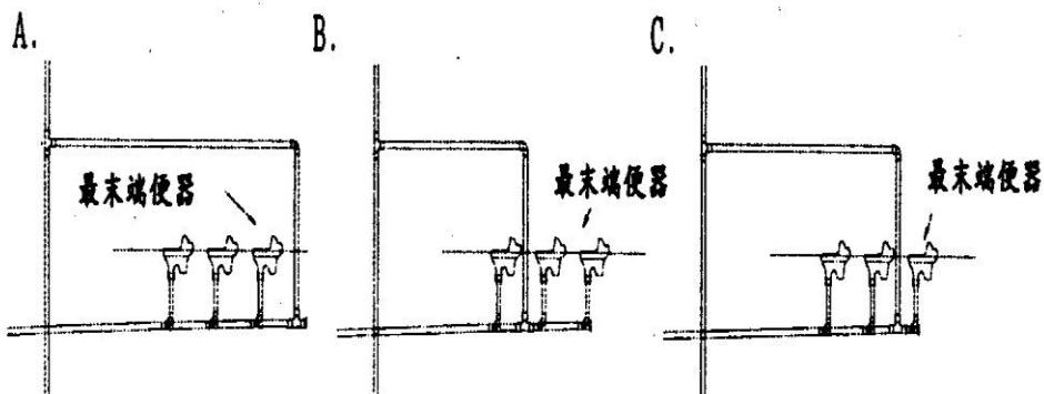
10. 下圖中之排水管合流處之配管方式，何者正確？
