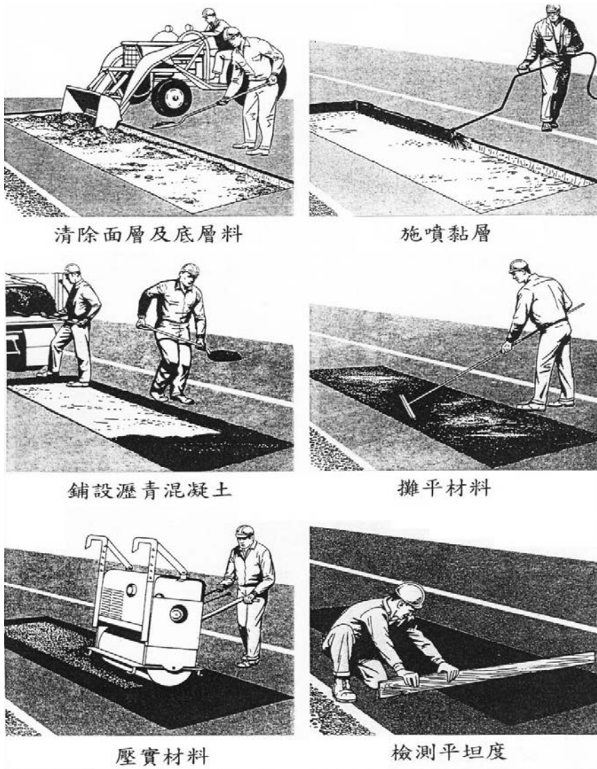
圖 28 路面局部挖除重鋪維修步驟
