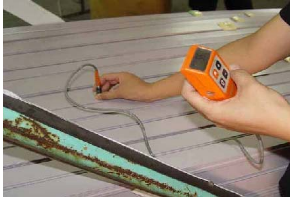
鋁門窗工程圖 1 皮膜厚度檢測
