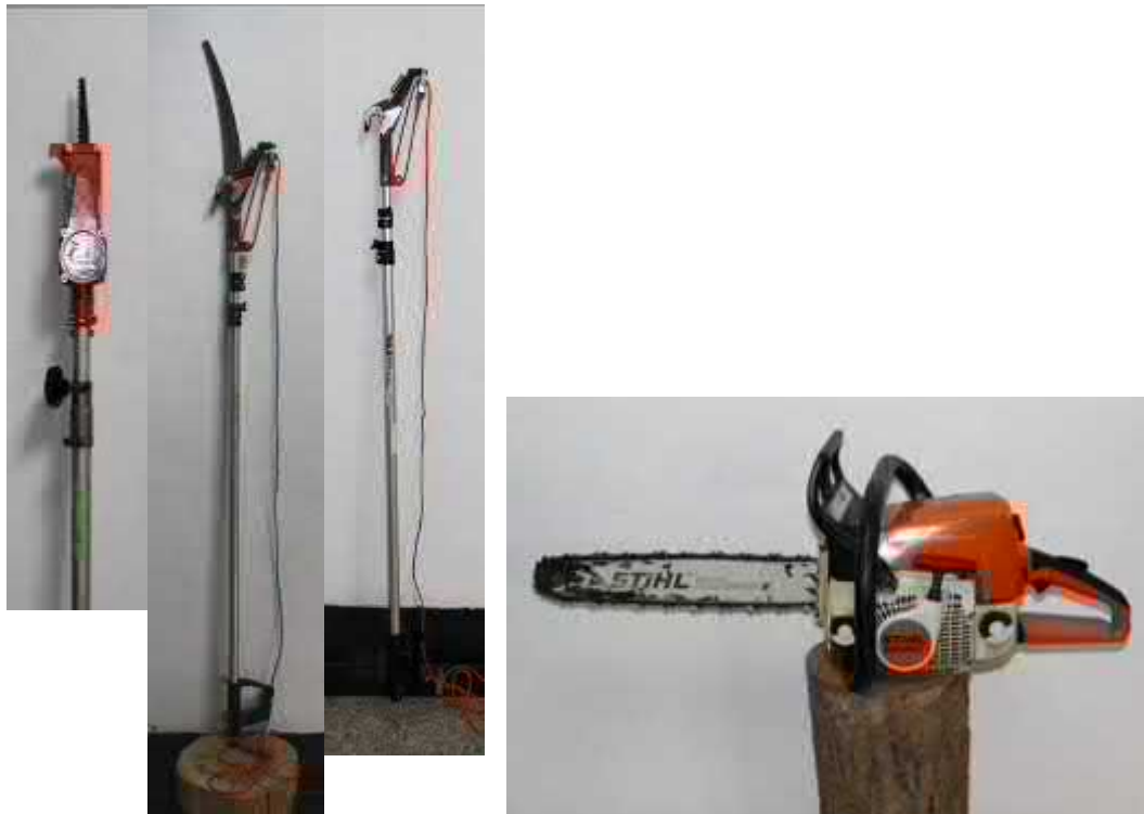
圖 I-37. 長柄伸縮型手鋸及修枝剪(左)，鏈鋸(右)。(邱志明 攝)
