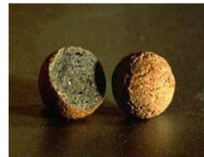
照片3 輕質骨材剖面構造
