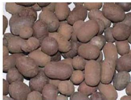
照片2 利用石門水庫淤泥燒製成的輕質骨材
