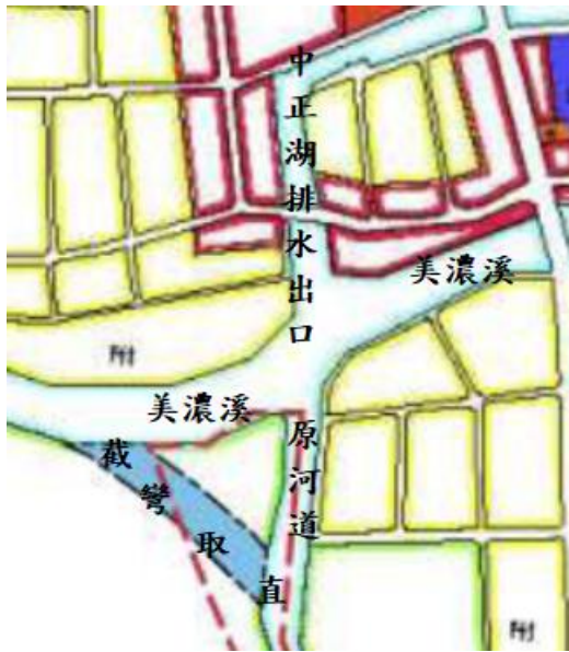
圖一、竹子門排水匯流入美濃溪採取截彎取直後改善消除水位頂托效應
