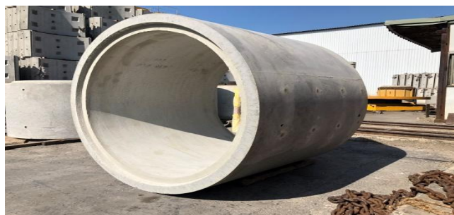
圖 6.3 推進用鋼筋混凝土管
