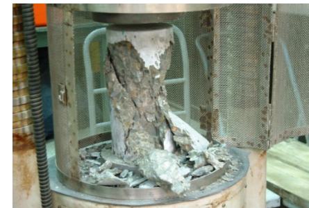
試體抗壓試驗
