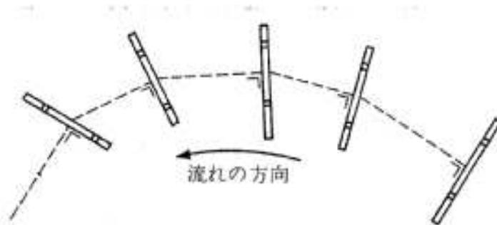
図 3-1-1 床固め工の方向
